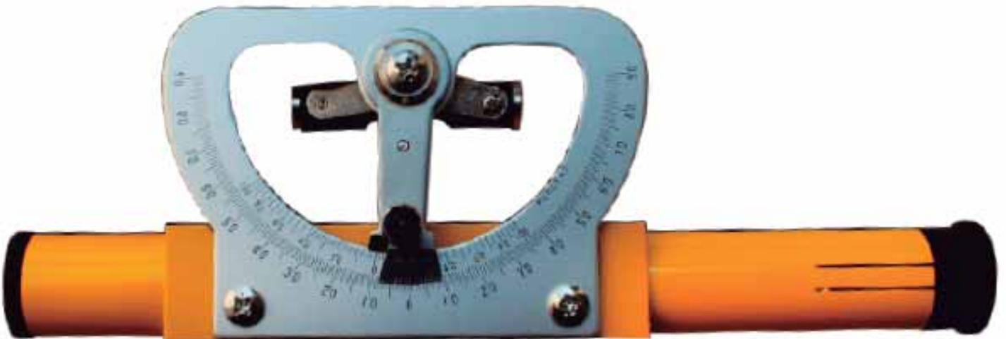
Aumento 5X con 1:100 stadia, 7-3/4" pulgadas de longitud, con tubo extendible a 8-5/8". El radio del arco esta graduado en grados de 0° a 90° en ambas direcciones; con lectura vernier a 10 minutos.
